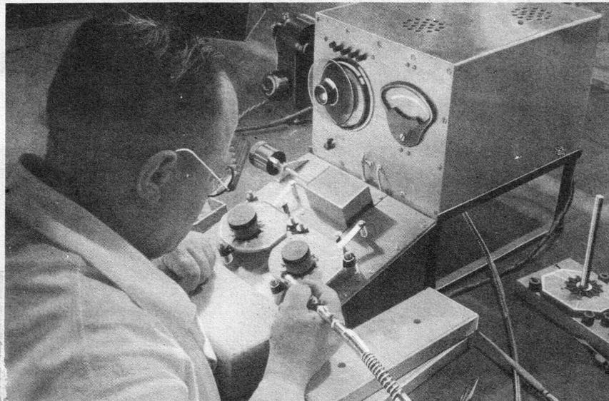
Das Schleifen der Wählerplatten für den Wählerautomaten. Auch hier wird die Einzelkapazität mit Hilfe einer Meßbrücke mit einem Normal verglichen.
